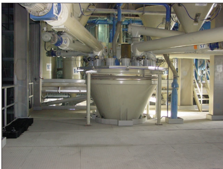
Автоматическое взвешивание и дозировка исходных сырьевых компонентов
