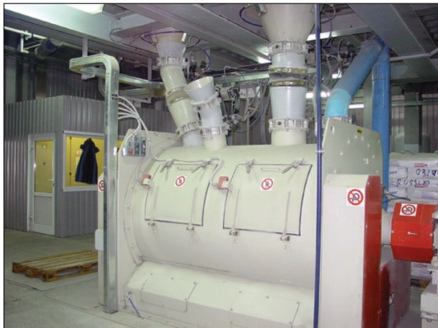
Автоматическое премешивание исходных сырьевых компонентов
